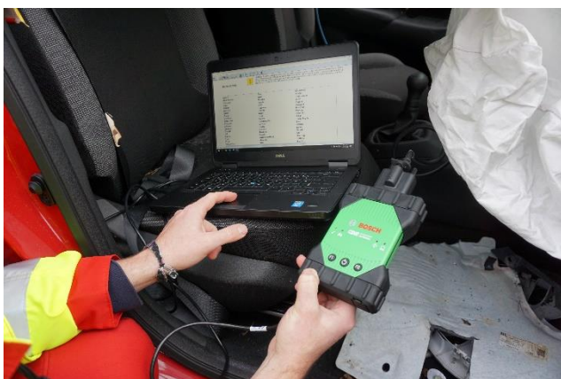
Auslesung eines Unfallfahrzeuges via OBD-Schnittstelle (inkl. Fremdbestromung des Fahrzeuges)
