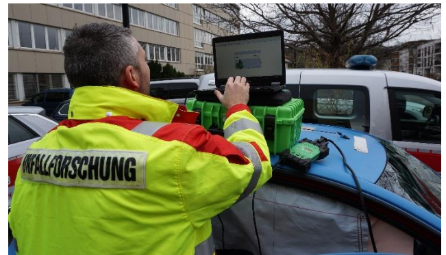
Auslesung eines Unfallfahrzeuges mit dem Bosch CDR 900 zur Erlangung eines EDR-Protokolls
