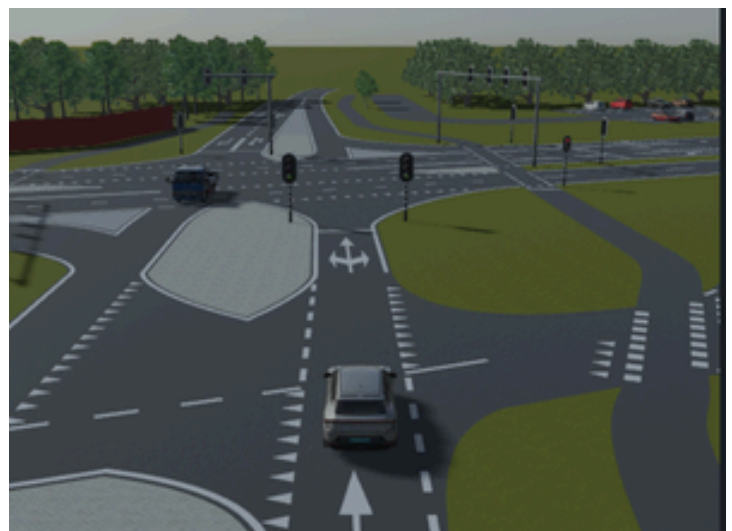
Ausschnitt aus einer ROADSCOR-Verkehrssimulation für eine zukünftige Variante eines Knotenpunktdesigns
