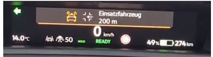
Information über Annäherung des VUFO-Technikerfahrzeuges in einem VW-Serienfahrzeug
